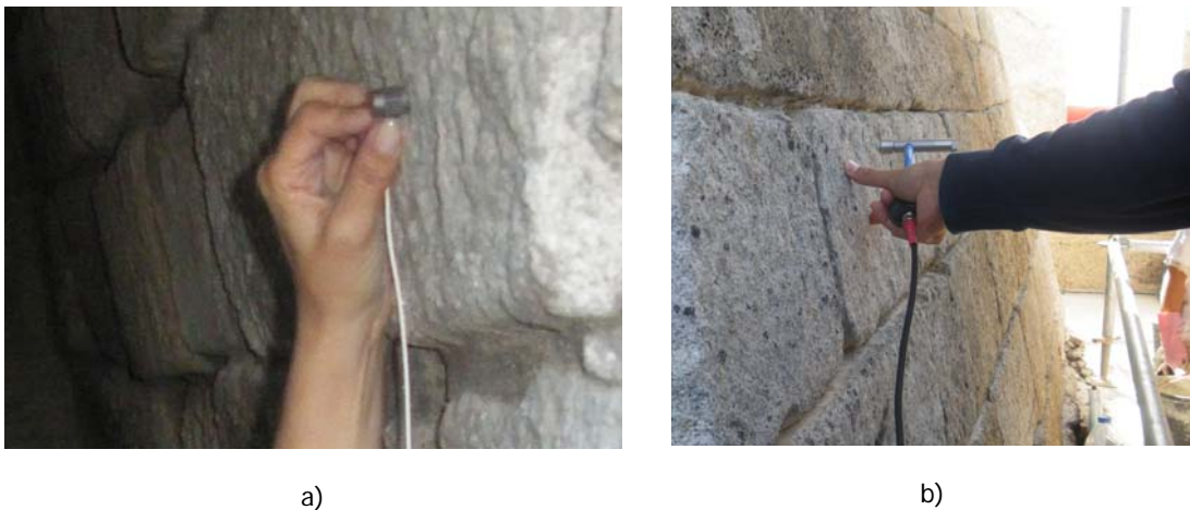
Figura 1: Ilustração de um Ensaio Sónico: a) acelerómetro na face interior da parede e b) martelo na face exterior da parede.
